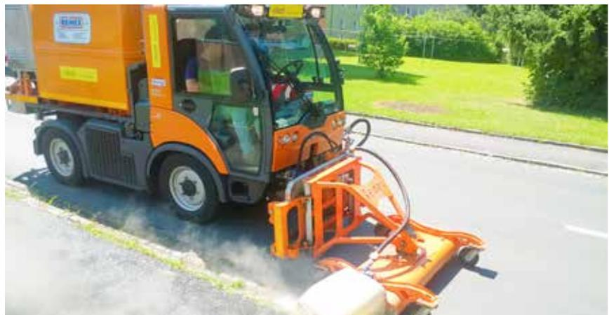
Einsatz so früh wie möglich erfolgen. Der Maschinenring Service hat das entsprechende Wasserdampf-Unkrautvernichtungsgerät, das dem neuesten Stand der Technik entspricht, vor kurzem angekauft. Der Vorteil: Es verbraucht entscheidend weniger Wasser als vergleichbare Geräte, verfügt über einen 1.800 l großen Wassertank und eine Arbeitsbreite von zwei Metern, was große Flexibilität und Reichweite bedeutet. Zwei zusätzliche Handlanzen mit verschiedenen Aufsät-
